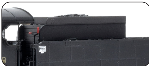
Tender con sopralzo carboniera e chiodature aggiuntive
