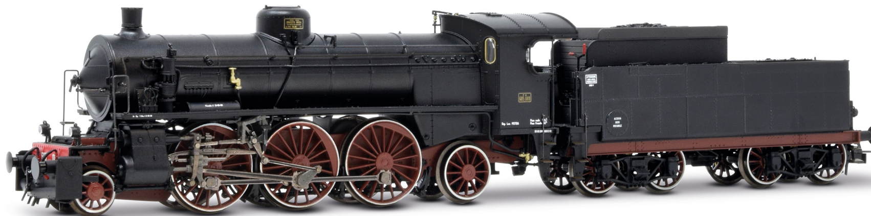
Tender con sopralzo carboniera e chiodature aggiuntive
